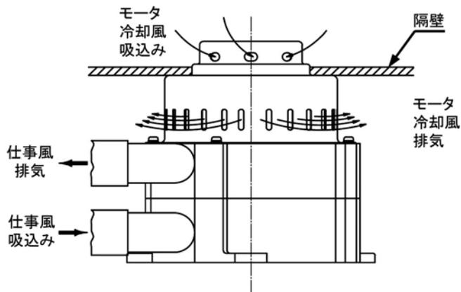
〈注〉バイパスタイプ、吸排気タイプのモータ冷却風は排気風と吸込風が循環(リーク)しないよう、隔壁などを設けて下さい
